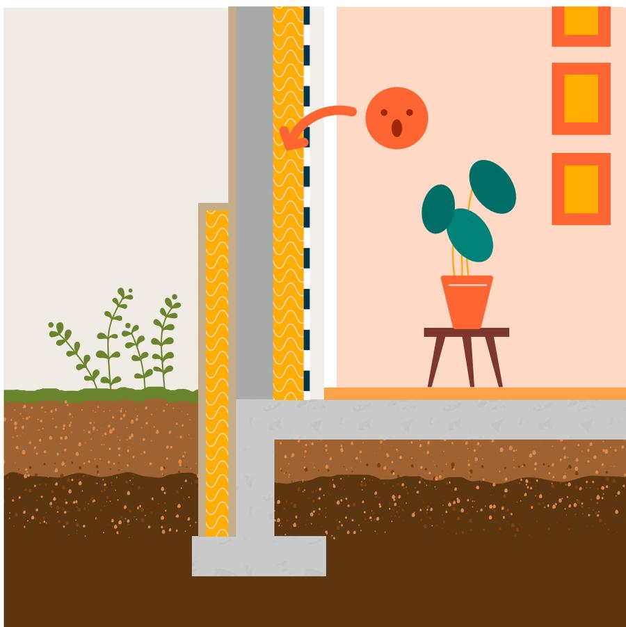
Si le sol ne peut pas être isolé directement (ni côté extérieur, ni côté intérieur), une isolation périphérique est réalisée pour compenser une partie des pertes de chaleur. Cependant il faudrait également augmenter la résistance d'isolation des murs. Sans vision globale du projet, l'isolation de l'enveloppe est trop faible, empêchant l'atteinte des consommations BBC-rénovation.
