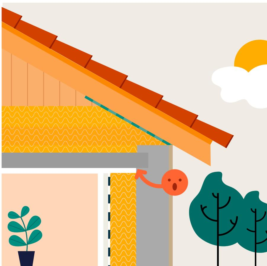
Si le plancher des combles est en béton, les isolants ne seront pas raccordés entre eux. La discontinuité de l'isolation va créer un pont thermique entre les murs et les combles. Ce pont thermique peut provoquer un phénomène de condensation entre le mur et le plafond.
