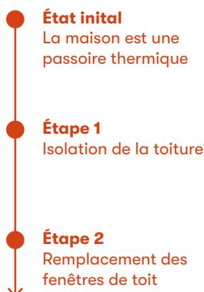
Si vous décidez d'isoler la toiture, il est important de maintenir toutes les fenêtres de toit dans le plan de la couverture. Les fenêtres seront donc déplacées une première fois en cas d'isolation par l'extérieur (sarking) et une seconde fois lors de leur remplacement avec une reprise des abergements (éléments destinés à faire la liaison étanche entre les matériaux de couverture et les fenêtres) et des finitions intérieures. Cela va générer des surcoûts.
